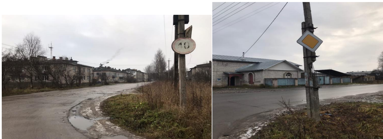
Рис. 1.7.2.2 – пересечение ул. Советская – ул. Чапаева износ дорожных знаков, дорожные знаки на старых опорах освещения
